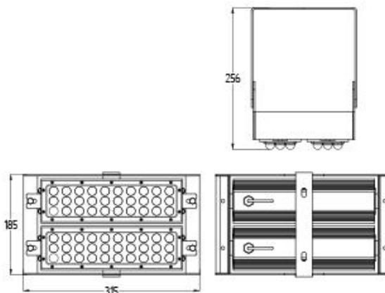
Алюминиевый корпус с развитыми ребрами и анодированным покрытием имеет великолепную теплоотдачу и исключает возможность перегрева. Светильники комплектуются системой вторичной оптики от 30 до 120 градусов, которая позволяет наилучшим образом распределять световой поток на освещаемой поверхности. Несмотря на небольшие размеры, светодиодные прожекторы обладают большим световым потоком, что обеспечивает высокий уровень освещенности объекта.
