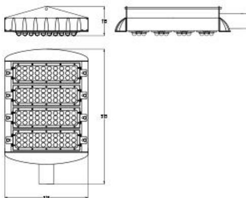
Детальная проработка конструктива светильника обеспечивает надежность всей конструкции. Драйверы спрятаны внутрь корпуса, что позволило наилучшим образом обеспечить гармоничный внешний вид. Такие светильники – это наилучшее решение для освещения магистралей, дорог, проезжих частей и парковок.
