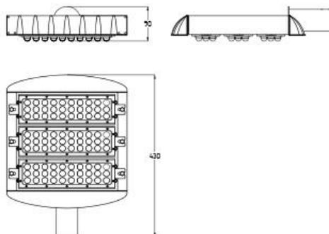
Использование запатентованной модульной технологии предусматривает возможность быстрой замены модулей «на месте». Герметичные разъемы позволяют за считанные секунды отсоединить модуль от светильника в случае выхода его из строя. Ключевой особенностью такой системы является то, что светильник не перестает работать даже в случае выхода из строя одного из модулей.
