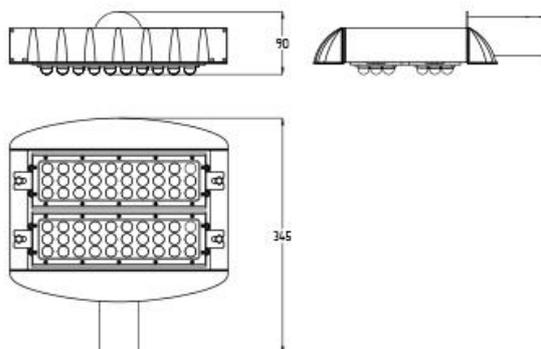
Анодированный профиль, метизы из высококачественной нержавеющей стали и надежная герметизация защищают светильник от коррозии и обеспечивают безопасную работу оборудования. Использование светодиодной оптики (блока линз) обеспечивает оптимальное распределение светового потока, причем как в светильниках со стандартной диаграммой, так и в светильниках с широкоградусной диаграммой.
