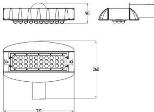
Уличные светильники серии MODULE HIGHWAY- это наилучший выбор для освещения дорог, автомагистралей, парковок и автостоянок. Эргономичное крепление позволяет устанавливать светильники на консоль диаметром до 50мм. Высококачественные светодиоды и драйверы обеспечивают безупречную бесперебойную работу на протяжении всего срока службы светильника.
