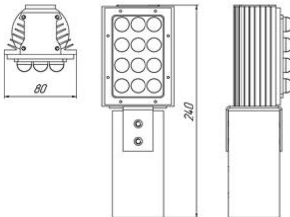
Серия небольших уличных светильников MODULE MINI применяется для освещения дворовых территорий, парковок, проезжей части и т.п. Эргономичное крепление позволяет устанавливать светильники на консоль диаметром до 50мм. Анодированный профиль, метизы из высококачественной нержавеющей стали и надежная герметизация защищают светильник от коррозии и обеспечивают безопасную работу оборудования.
