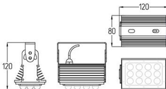
Светодиодные прожекторы предназначены для архитектурной подсветки зданий, освещения парковых зон, дворовых территорий. Конструкция прожектора и применяемые материалы обеспечивают высокую механическую прочность и полную защиту от проникновения пыли и влаги по классу IP66. Небольшие габариты позволяют монтировать светильник на фасады зданий, не привлекая к себе внимание.
