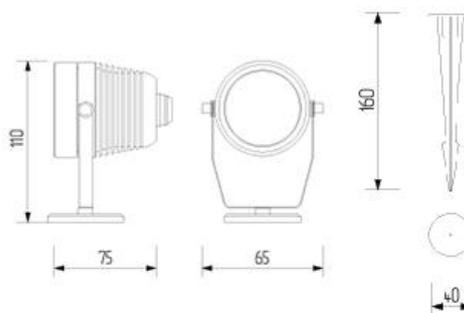
Светодиодный прожектор BRAVO 65 в стильном компактном корпусе идеально подойдет для создания световых акцентов на небольших объектах. Несмотря на свои небольшие размеры, корпус светильника выполнен из качественного алюминиевого сплава, который обеспечивает необходимую теплоотвод. Светильник представлен как моно цветах – белый нейтральный, белый теплый, белый холодный, красный, синий, зеленый и желтый так и РГБ. В комплектацию светильника входит грунтовой кронштейн.
